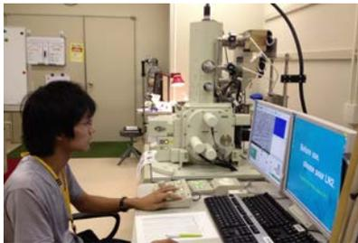
研修課題は、「高温で形状記憶効果が現れるチタン-白金系の形状記憶合金の形状記憶効果について」で、材料の変態温度の評価、内部組織の観察及び機械的特性についての実習を行いました。NIMSには、最新鋭の測定装置が多数導入されていて、学生も、示差走査熱量計、X線回折装置、走査型電子顕微鏡、万能材料試験機などの装置を使い、実際に測定と材料特性の評価を行いました。
