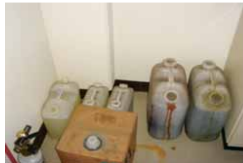
指摘事項2. 実験室の隅に置かれた実験廃液のポリ容器
