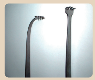
鑄造により作られた 形状記憶合金製治療器具
