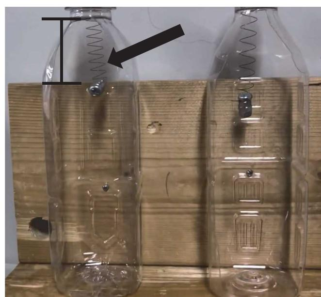
図 2. 形状記憶特性バネ（左側のバネ）をヘアドライヤーで
