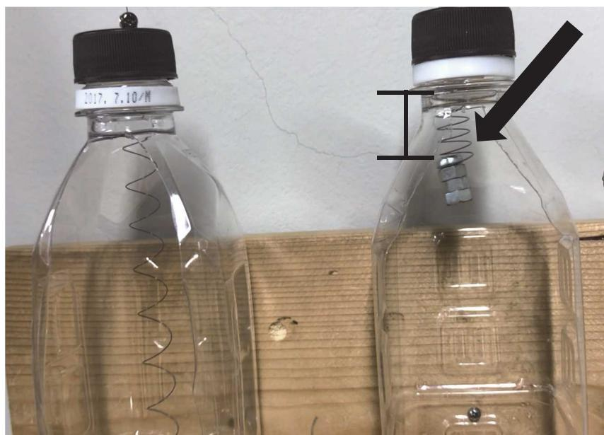
図 6. 超弾性特性バネを室温からヘヤドライヤーで加熱を行った時の教材の概要
