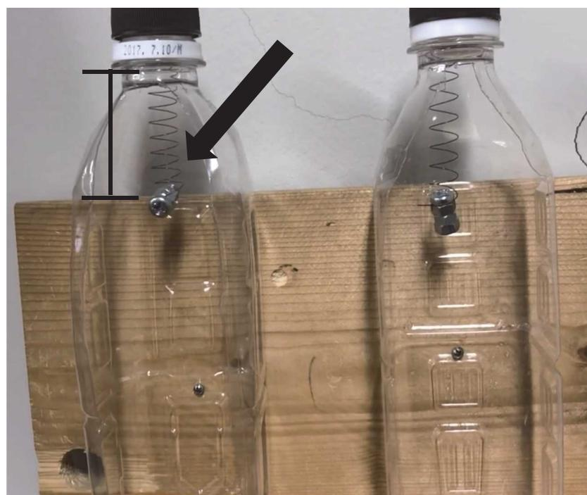
図4. 形状記憶特性バネを冷却スプレーで冷却後
