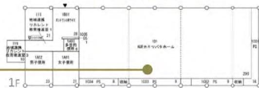
ホールは様々な使用形態に対応できるよう可動間仕切を設置し、1室、2室、3室利用を可能にし、学び方に柔軟に対応できる空間とした。大空間として利用する際は、天井面のロールスクリーンを開閉し、使用形態に併せて室の雰囲気を大きく変える。スライディングウォールでホールを2室～3室に小部屋割にして利用することができる。
