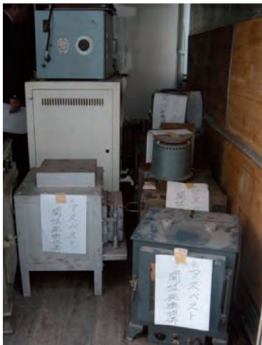
アスベスト含有廃棄備品
