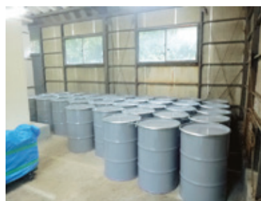
高濃度 PCB 汚染物 保管状況
