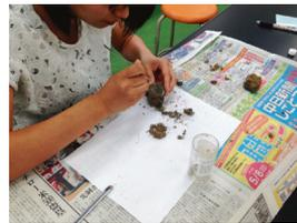
西三河南部で採取された掘削（ボーリング）試料を処理中の学生。削り出した泥や砂を化学的に処理し、プレパラートを作成して顕微鏡で観察する。
