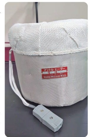
15個中8個がアスベスト含有製品だったマントルヒーター
